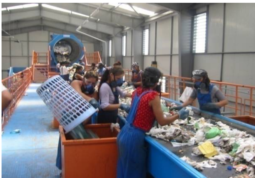
Figura 5.2.2.3-8: Linie manuala de sortare
